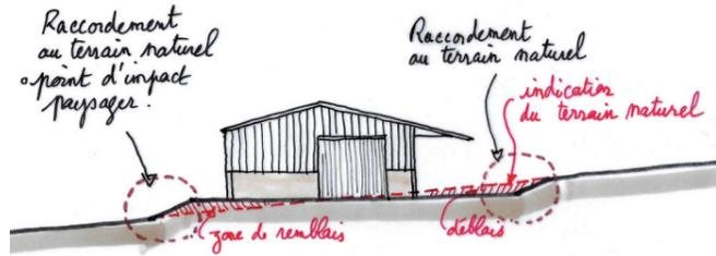
L'implantation sur la parcelle nécessite une réflexion préalable sur les vues proches (1 et 2) et lointaines (3) du bâtiment.
